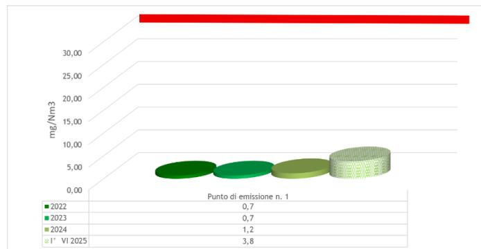
Figura 7.6.2 - Concentrazione di acido cloridrico nelle emissioni convogliate rispetto al valore limite di emissione (in rosso), in mg/Nm<sup>3</sup>
