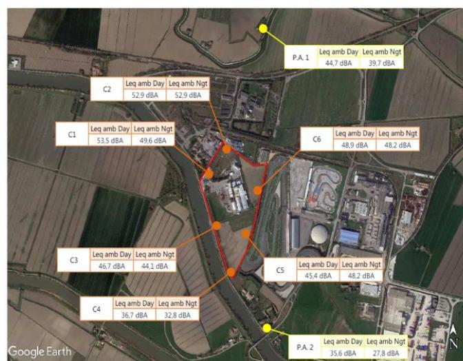
Figura 7.7.1 - Punti di misura acustica ai confini dello stabilimento
