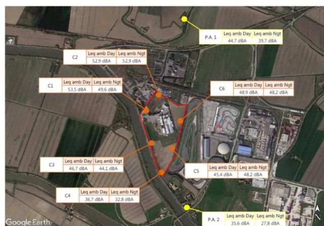
Figura 7.7.1 - Punti di misura acustica ai confini dello stabilimento
