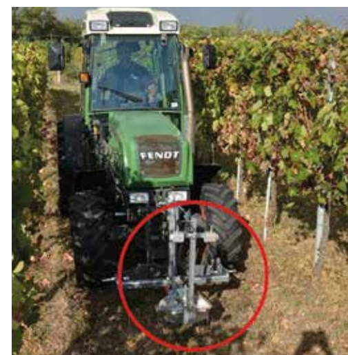
FIGURA 2. I sensori multiparametrici (cerchiati in rosso) per la rilevazione delle caratteristiche fondamentali del vigneto sono installati a sbalzo sulla parte anteriore del trattore, per poter pilotare in tempo reale la distribuzione VRT del fertilizzante organico, effettuata dal prototipo al traino
