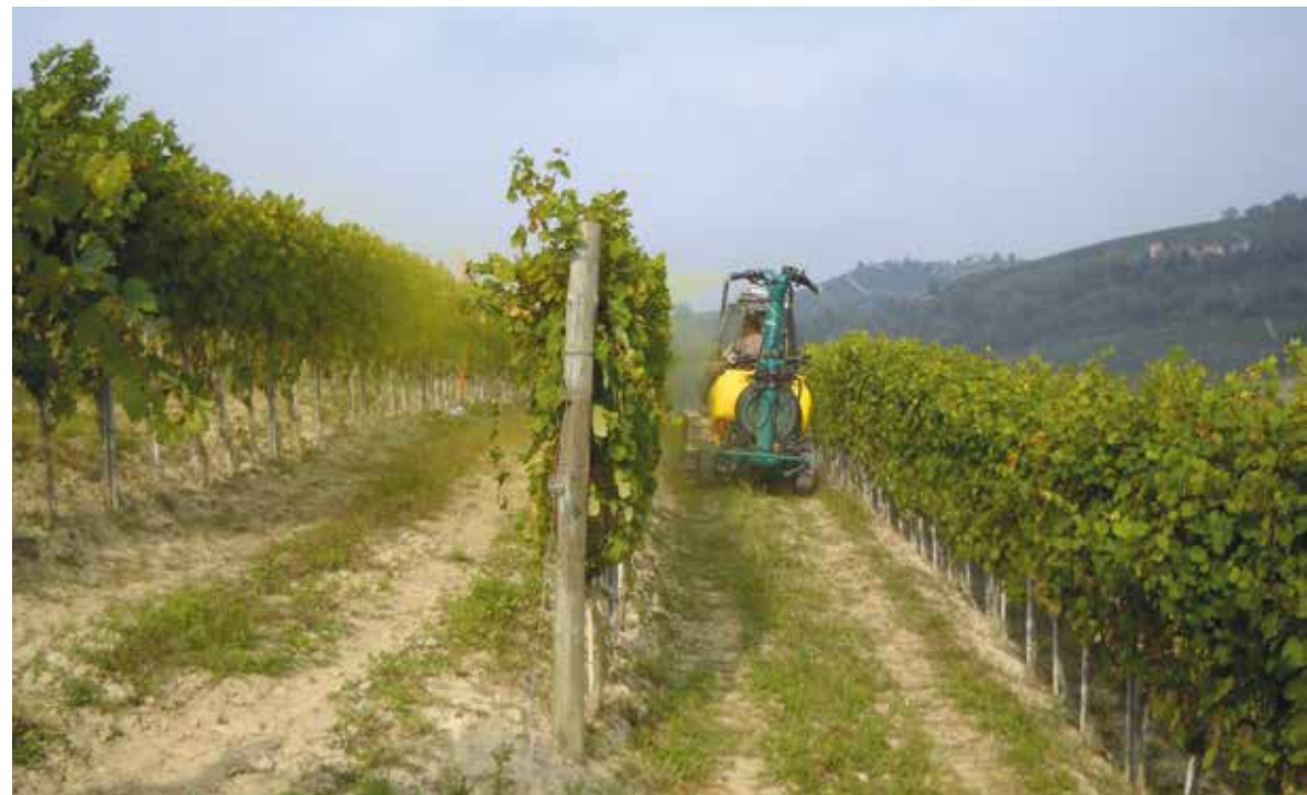
FIGURA 6. Irroratrice pneumatica in vigneto (foto G. Oggero - Disafa)
