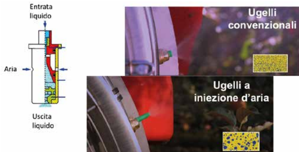
FIGURA 5. Riduzione della deriva in vigneto con l'impiego di ugelli ad iniezione d'aria (prove Disafa in vigneto)
