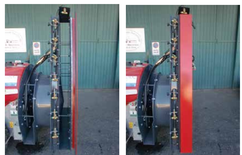
FIGURA 12. Irroratrice equipaggiata con un sistema che permette di chiudere le sezioni di uscita dell'aria sia sul lato destro sia sul lato sinistro (foto M. Tamagnone - Disafa).
