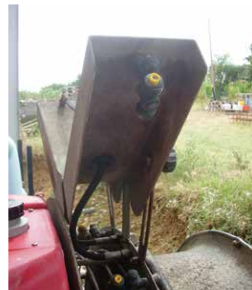
FIGURA 9. Esempio di deflettori dell'aria regolabili. Si noti il posizionamento dell'ugello sull'aletta, soluzione che permette una più facile regolazione dell'ampiezza del getto erogato dalla macchina (foto G. Oggero - Disafa)
