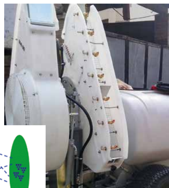
FIGURA 10. Qui a fianco, esempio di gruppo di distribuzione a torretta con elementi inclinabili (foto G. Oggero - Disafa); sotto, schema di funzionamento di una irroratrice con gruppo di distribuzione a diffusori orientabili
