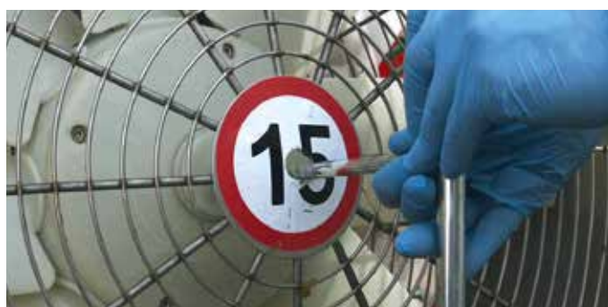
FIGURA 8. Regolazione manuale dell'inclinazione delle pale del ventilatore assiale dell'irroratrice (foto G. Oggero - Disafa)
