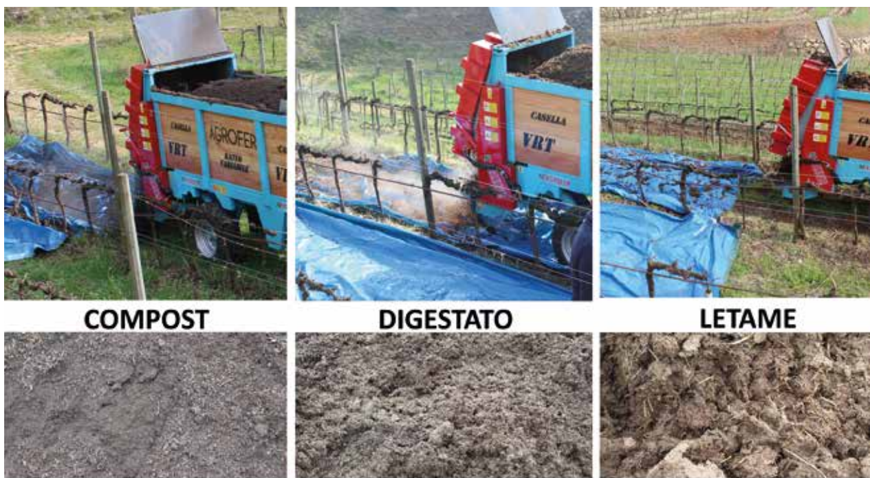
FIGURA 1. I prototipi in sviluppo stanno lavorando con 3 differenti matrici organiche, ovvero letame bovino maturo, compost da materiale verde e misto e componente solida del digestato da biogas
