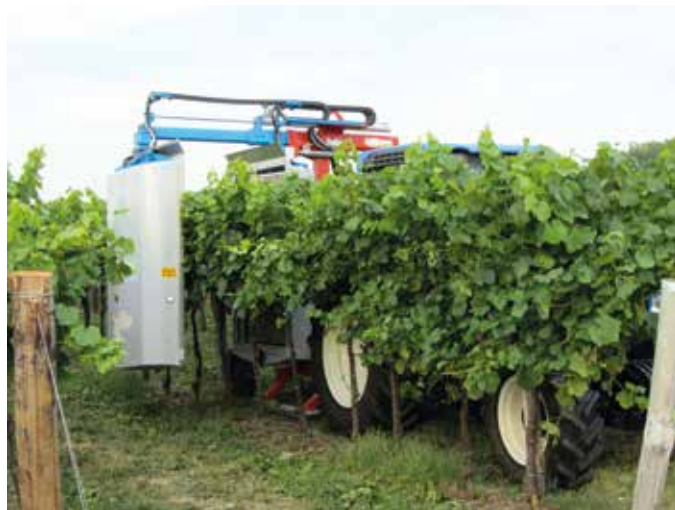
FIGURA 15. Irroratrice con sensori per l'adattamento della distribuzione (apertura e chiusura ugelli, passaggio da ugelli convenzionali ad ugelli antideriva) alle condizioni ambientali
